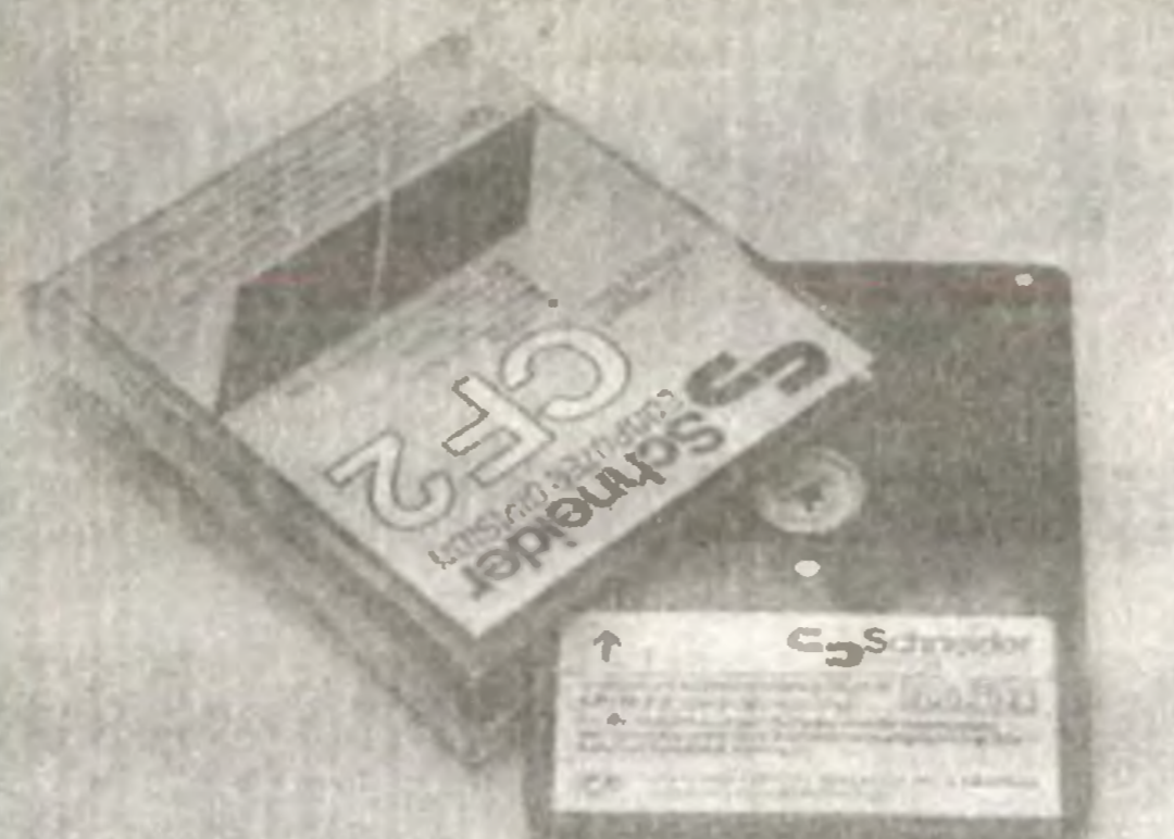
Dyskietka 3" stosowana przez firmę Amstrad (Schneider) w komputerach CPC 664 i CPC 6128 (pojemność 2 x 180K)
